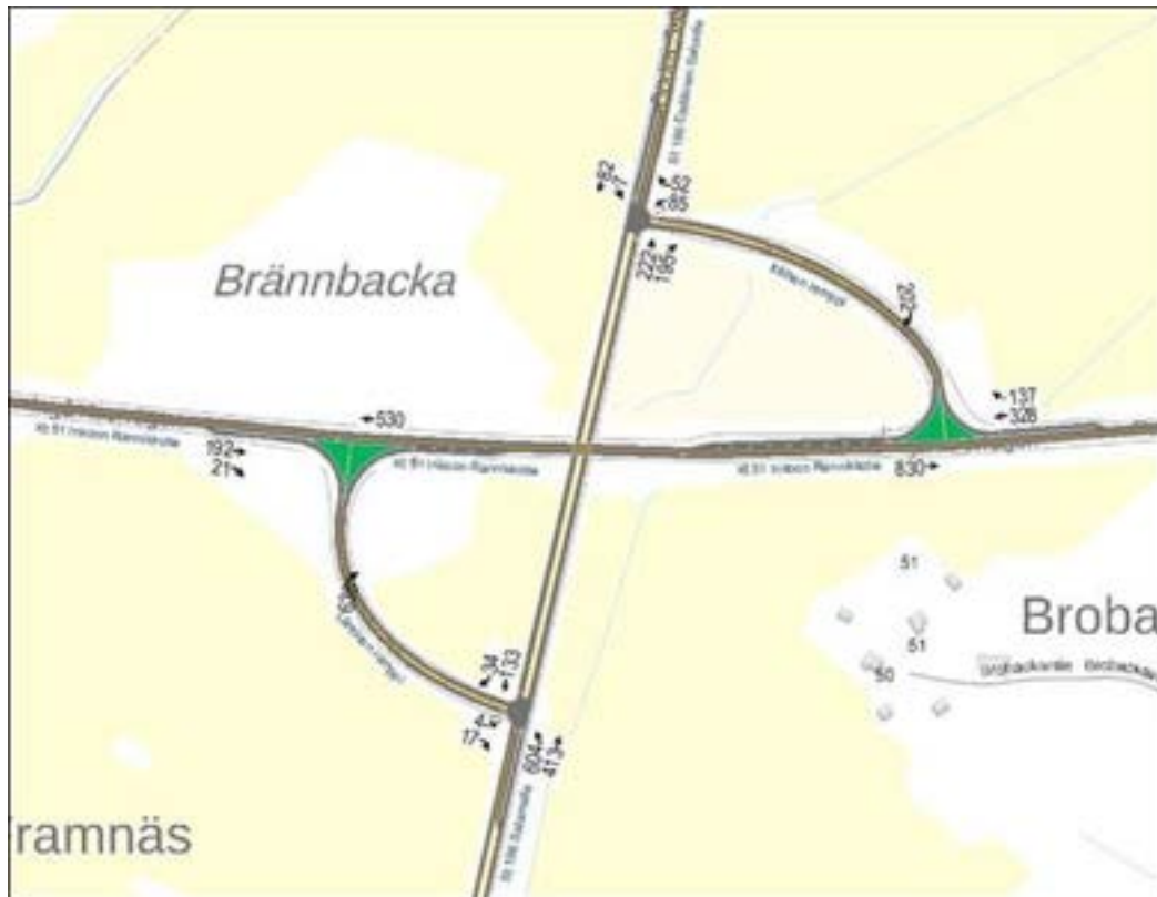
Kuva 31. Rakentamisen aikaisen huipputunnin liikennemäärät tilanteessa, jossa työntekijät poistuvat alueelta ja liikennejärjestelyt ovat nykyiset.
