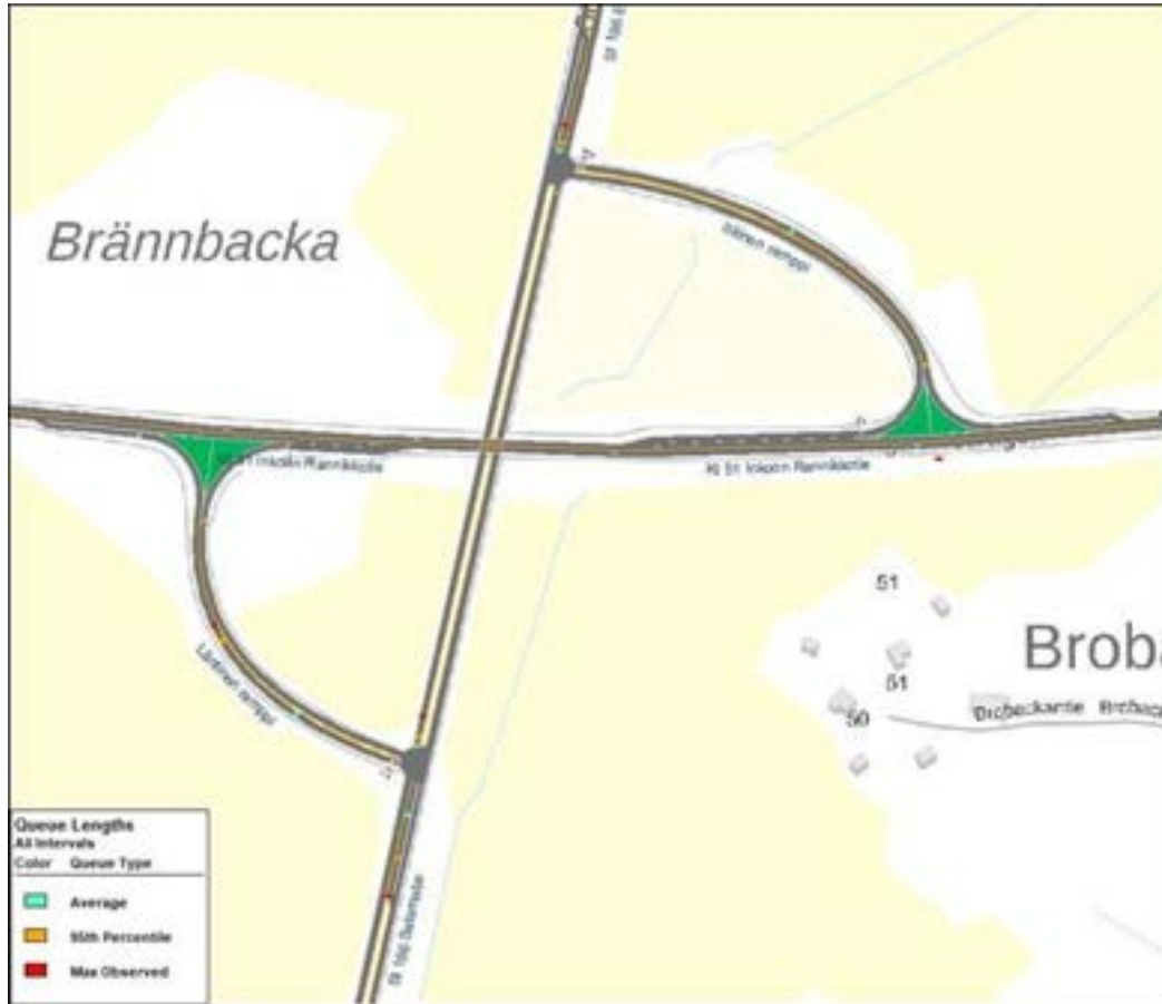
Kuva 35. Eritasoliittymän jonoutuminen huipputuntina rakentamisen aikaisessa tilanteessa nykyisillä liikennejärjestelyillä.
