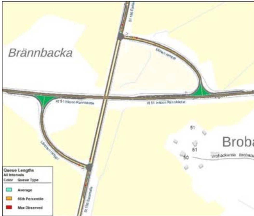
Kuva 33. Eritasoliittymän jonoutuminen huipputuntina rakentamisen aikaisessa tilanteessa nykyisillä liikennejärjestelyillä.
