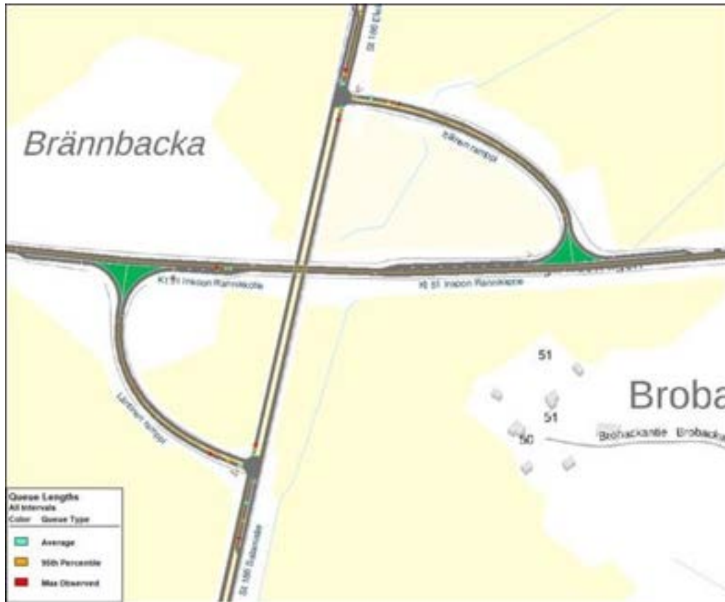
Kuva 37. Eritasoliittymän jonoutuminen huipputuntina rakentamisen aikaisessa tilanteessa nykyisillä liikennejärjestelyillä.
