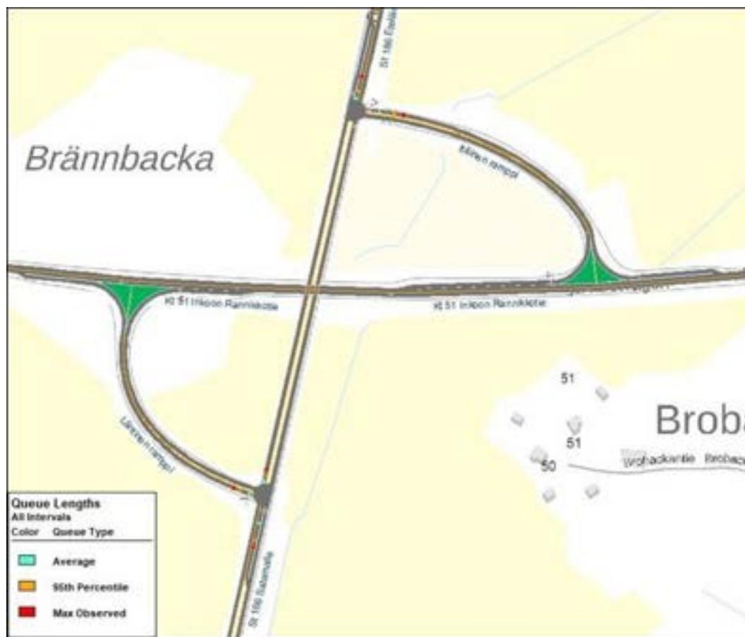
Bild 33. Köbildning under maxtimmen vid planskilda trafikplatsen under byggtiden med nuvarande trafikarrangemang.
