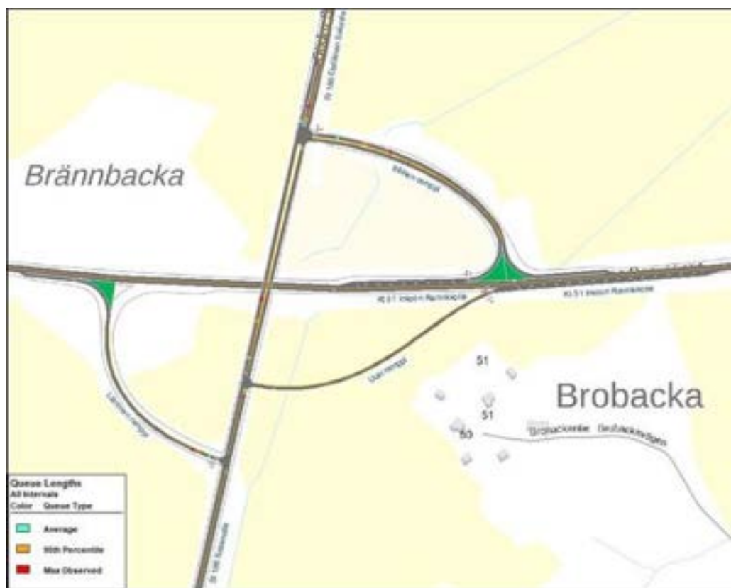
Bild 27. Köbildning vid planskilda trafikplatsen under kvällens maxtimme i projektionsscenario för 2050 med förbättrad trafikledning.
