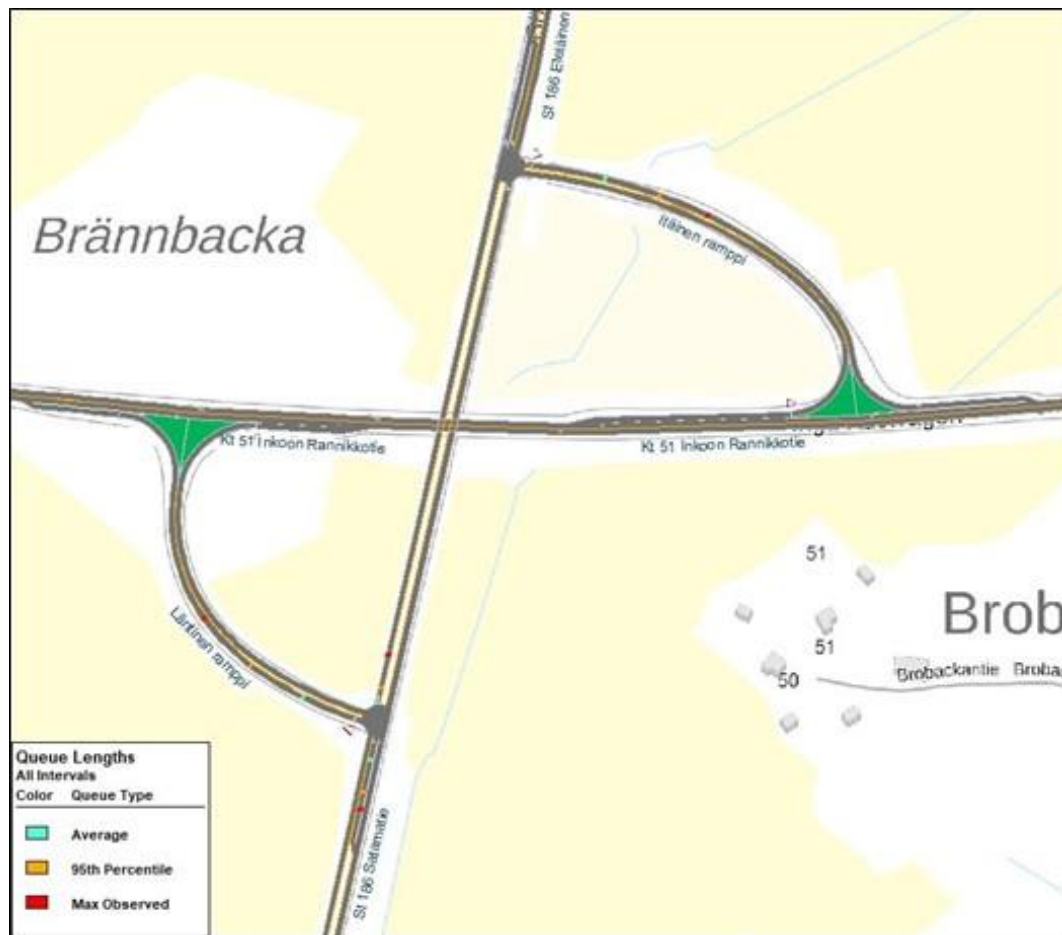
Bild 30. Köbildning under maxtimmen vid planskild trafikplatsen under byggtiden med nuvarande trafikförhållanden.
