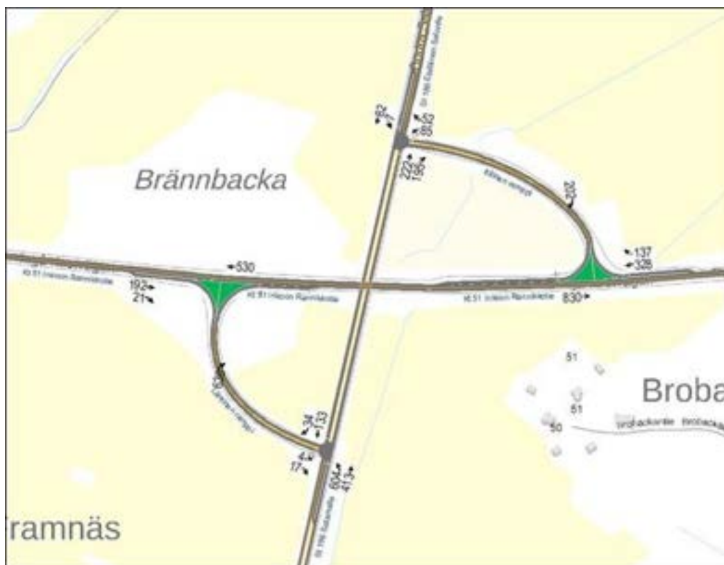
Bild 31. Trafikvolymerna under maxtimmen under byggtiden i ett scenario där arbetarna lämnar området och trafikarrangemangen förblir som de är.
