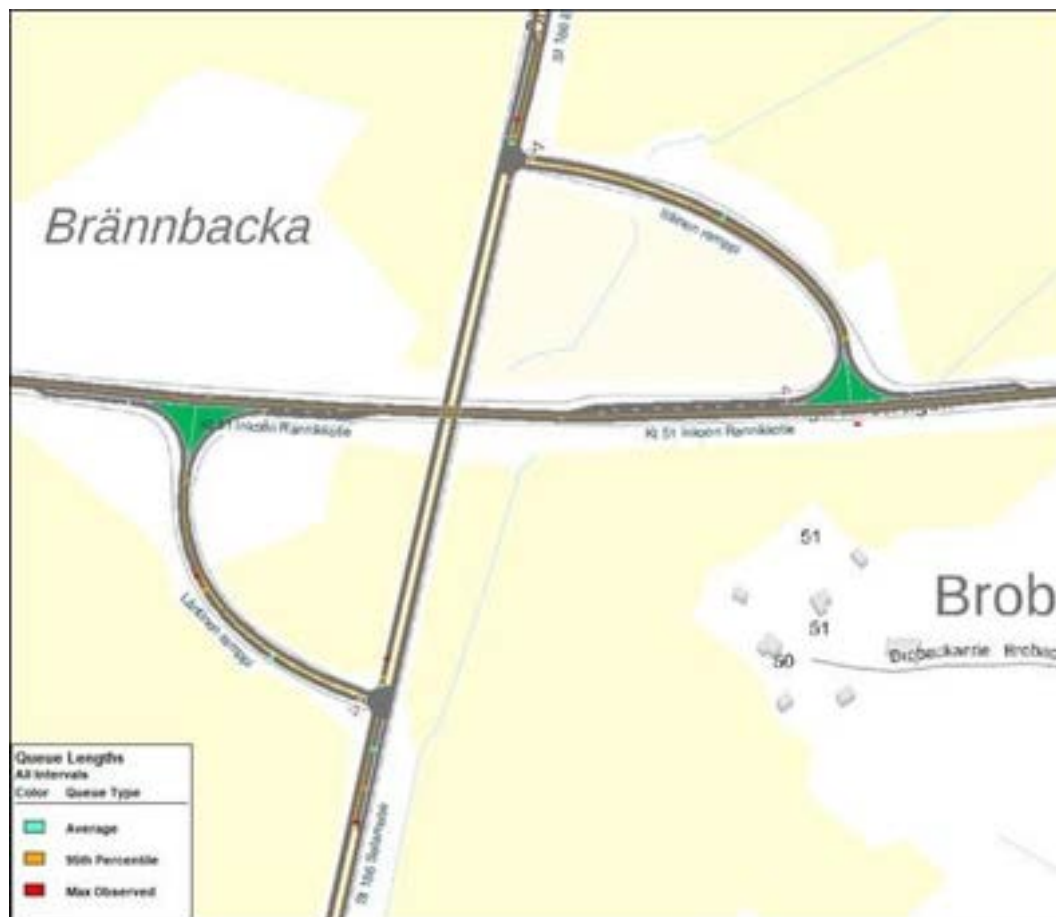
Bild 35. Köbildning under maxtimmen vid planskilda trafikplatsen under byggtiden med nuvarande trafikförhållanden.
