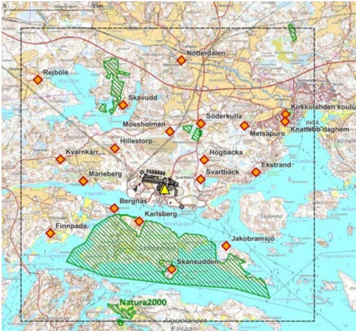
Kuva 76. Ilmapäästöjen leviämismallinnuksessa tarkasteltu alue: laskentaverkon reunat (musta katkoviiva), suunnitellut tehdasalueen rakennukset (harmaa), päästölähteinä käytettyjen kahden piipun sijainnit (keltaiset kolmiot), mallin erilliset reseptoripisteet Inkoon alueella ja Raaseporin Rejbolessä (punakeltaiset vinoneliöt) ja luonnonsuojelualueet (vihreä viivoitus). AFRY Finland Oy 2024d. Karttapohja: Maanmittauslaitoksen maastokartta.
