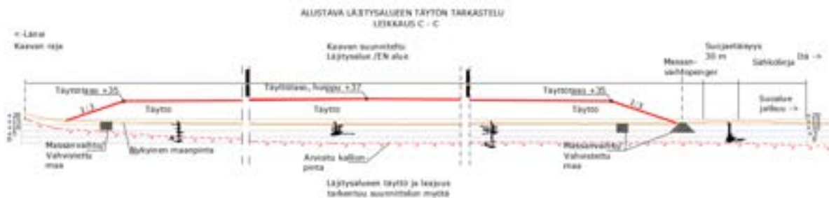
Bild 82. Tvärsnitt ur utredningen av deponeringsområdet, granskad toppnivå +37. Kommer att preciseras under planeringen av deponeringsområdet.
