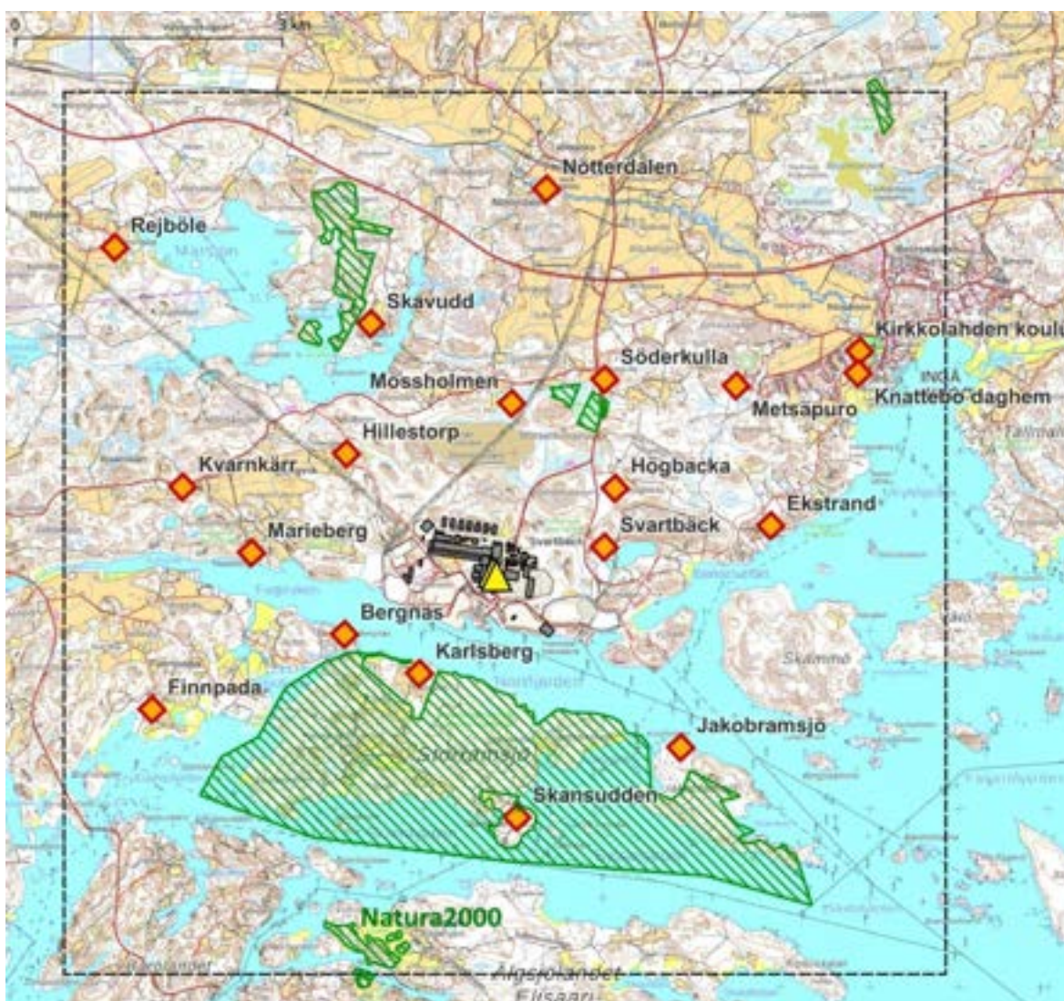
Bild 76. Området som undersökts i modelleringen av hur utsläppen i luft sprids: beräkningsnätets kanter (svart streckad linje), planerade byggnader på fabriksområdet (grå), läget för två skorstenar som utgör utsläppskällor (gula trianglar), modellens olika receptorpunkter inom Ingåområdet och i Rejbole i Raseborg (röd gula romber) och naturskyddsområden (grön streckning). AFRY Finland Oy 2024d. Kartunderlag: Lantmäteriverkets terrängkarta.
